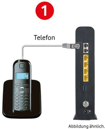
**Analoges Telefon:** Stecken Sie den Stecker in den Anschluss TEL1 oder LINE1 Ihres Kabel-Routers:
